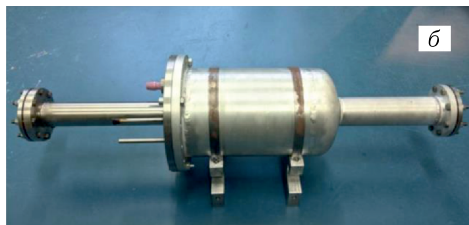
Рис. 1. а ) Схема, иллюстрирующая принцип работы ВПК в режиме активной мишени; б ) сосуд высокого давления ВПК АСТАМ. Линейные размеры конструкции, включая трубы ввода и вывода пучка, составляют порядка 1000 мм
